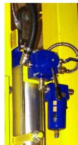
Пневмосистема сваебойной установки включает: средство очистки воздуха - фильтр влагоотделитель, управляющие элементы. От распределителя сжатый воздух подводится к пневмоцилиндру и по резиновому рукаву к пневмомолоту.
